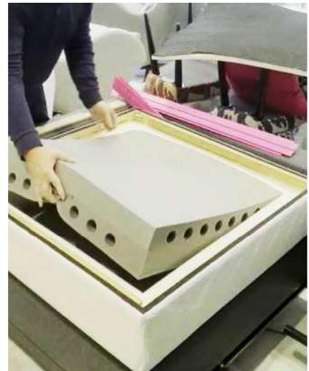
Hemos desarrollado un **sistema de construcción y montaje que permite separar todos los componentes que forman la almohada de asiento** para que el núcleo de goma del asiento pueda ser reemplazable de una forma fácil y económica, y así alargar la vida de estos sofás.
